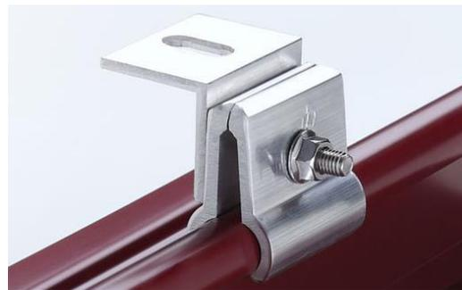
Für die bauseitige Befestigung von Montageschienen für Solar- bzw. Kollektoranlagen ist mittels der Befestigungsschraube an den Klemmbacken ein Winkel 40 x 40 x 4 mm angebracht. Der Winkel ist so zu montieren, dass er an einer Außenseite der Backen anliegt.
